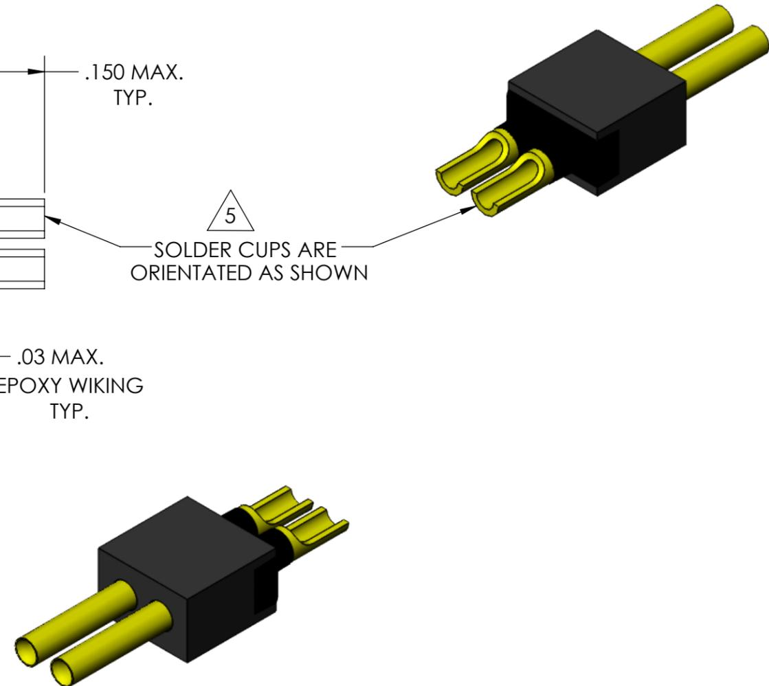
5 SOCKET SOLDER CUPS ARE ONLY GOOD FOR 26 AWG AND SMALLER WIRE.
